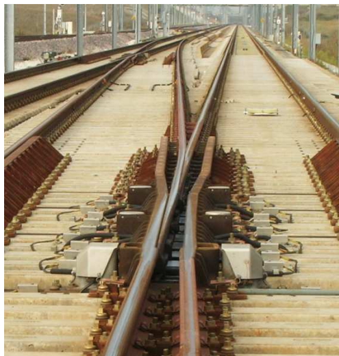
Obrázek 40: /FR/: Dva příklady srdcovek s pohyblivým hrotem (zdroj: Vossloh Cogifer SA).
