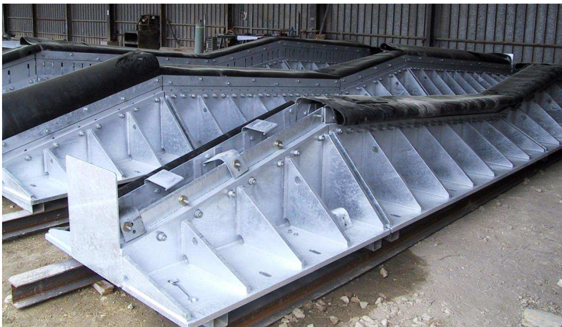
Obrázek 56: /FR/: Výroba přepážek kolejového lože pro koleje v převýšení (zdroj: ETIC).
