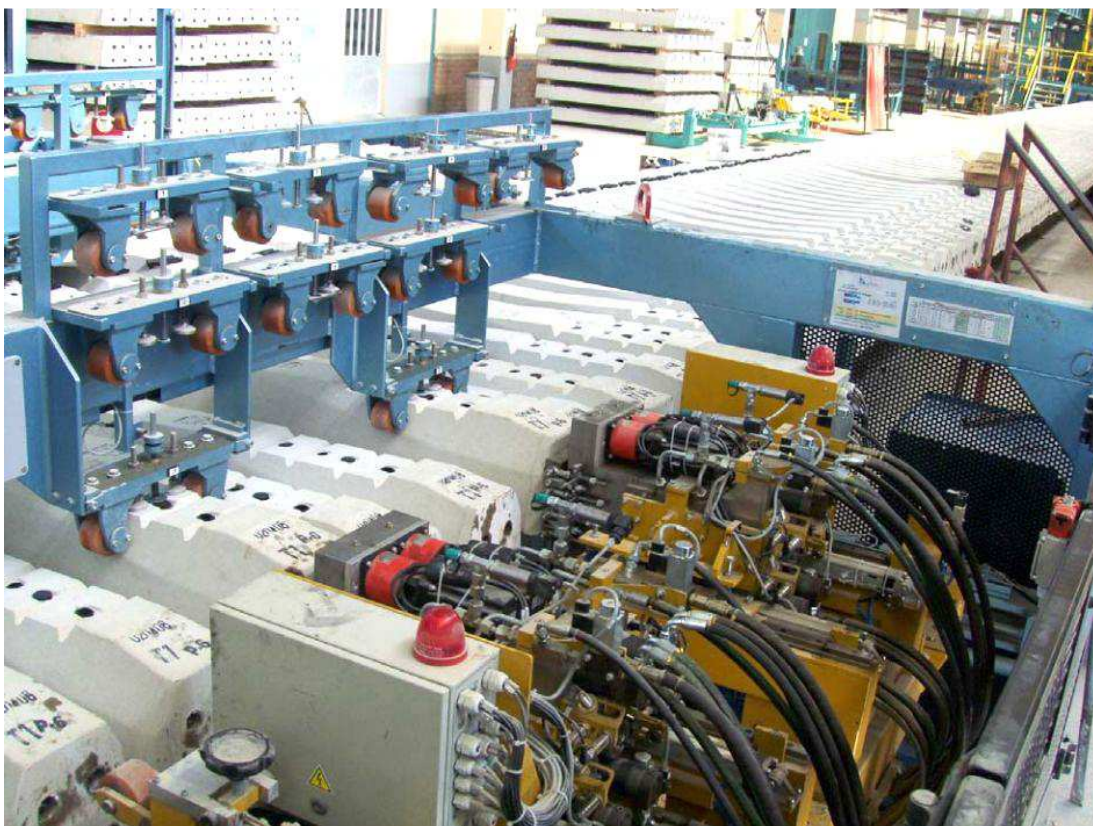
Obrázek 14: Dodatečné předpínání pražců u výrobce PRECON ve Španělsku (Zdroj: Asociación Nacional de Fabricantes de Traviesas para Ferrocarril).
