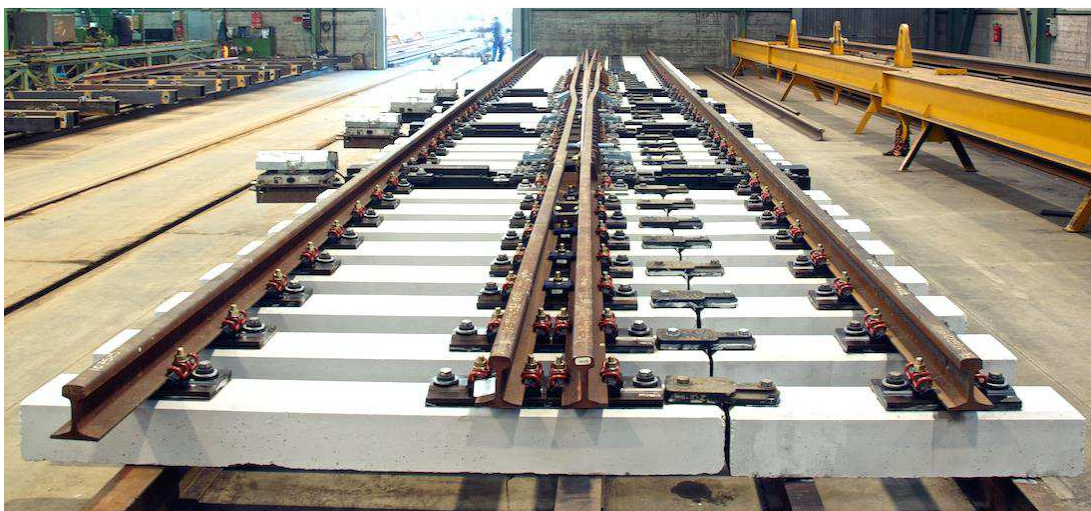
Obrázek 44: /ES/: Výhybka s dělenými pražci (Zdroj: amurrio ferrocarril y equipos, s.a.)
